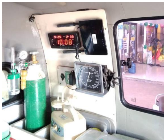
รูปที่ 3 ที่ยึดโทรศัพท์ในรถด้านหลัง และจุดติดตั้ง Wifi Router บนรถกู้ชีพ
