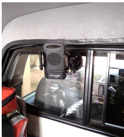
รูปที่ 3 ที่ยึดโทรศัพท์ในรถด้านหลัง และจุดติดตั้ง Wifi Router บนรถกู้ชีพ
